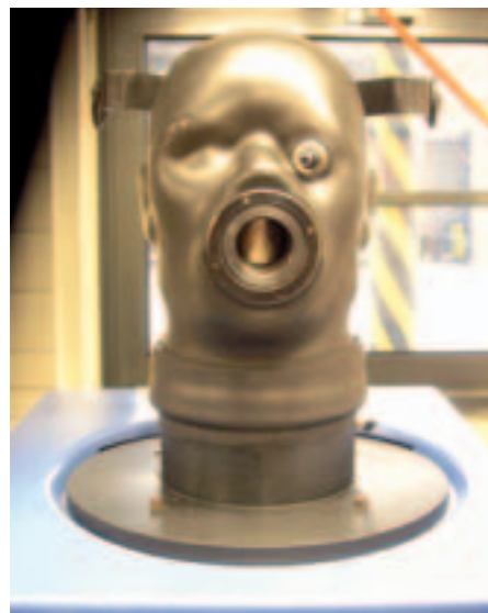
Cvičná „hlava“ sloužící k seřizování nezbytných dýchacích přístrojů
